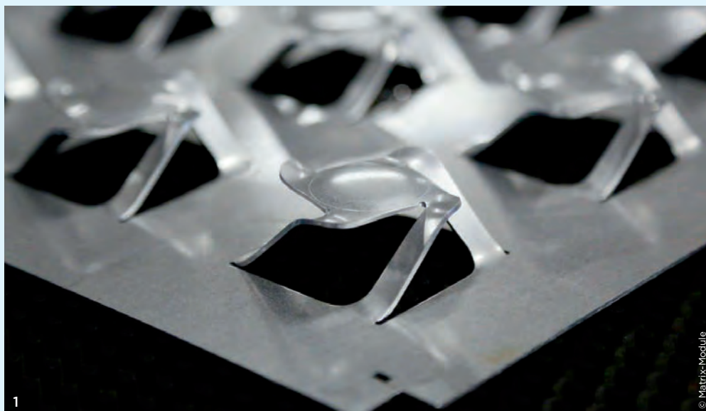
1 „Vogelperspektive“: Einzelelement der Necto-Struktur. 2 Das Necto-Sandwich von unten 3 Reko-Motorhaube eines klassischen Sportwagens mit GFK-Decke auf Aluminiumstruktur: 6 statt 15 Kilogramm.
