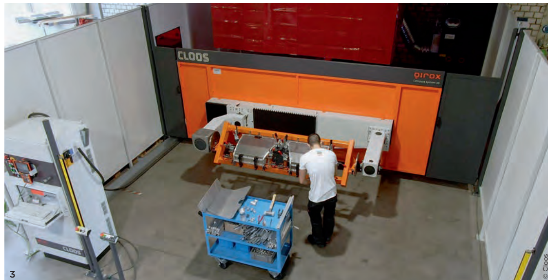
3 Durch den 2-Stationen-Aufbau kann die Qirox-Anlage auf der einen Seite bestückt werden, während auf der anderen Seite der Roboter schweißt. 4 Unter anderem schweißt Multi-cycles Seitengitter des Aluminium-Transportkorbs mit der Roboteranlage.
