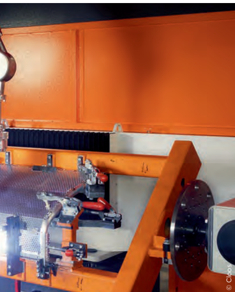
3 Durch den 2-Stationen-Aufbau kann die Qirox-Anlage auf der einen Seite bestückt werden, während auf der anderen Seite der Roboter schweißt. 4 Unter anderem schweißt Multi-cycles Seitengitter des Aluminium-Transportkorbs mit der Roboteranlage.
