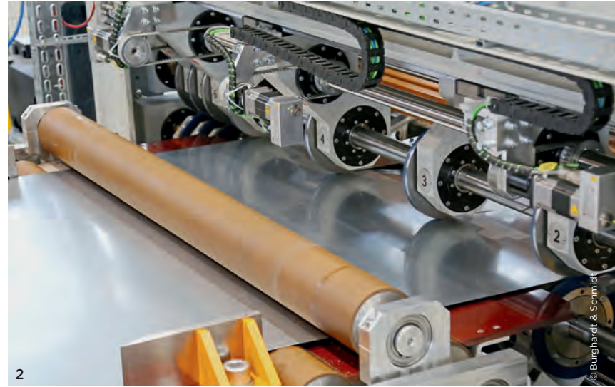
1 Die gesamte Längsteilanlage von oben 2 Auch wenn hier nur drei Streifen erzeugt werden, sieben wären möglich – weit mehr als branchenüblich.
