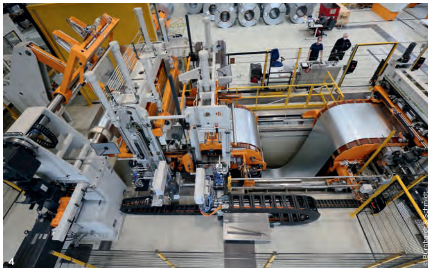
3 Das Bestücken der Anlage mit einem neuen Coil erfolgt hoch automatisiert. 4 Der Auslaufbereich mit Schlingengrube und Aufwickelhaspel
