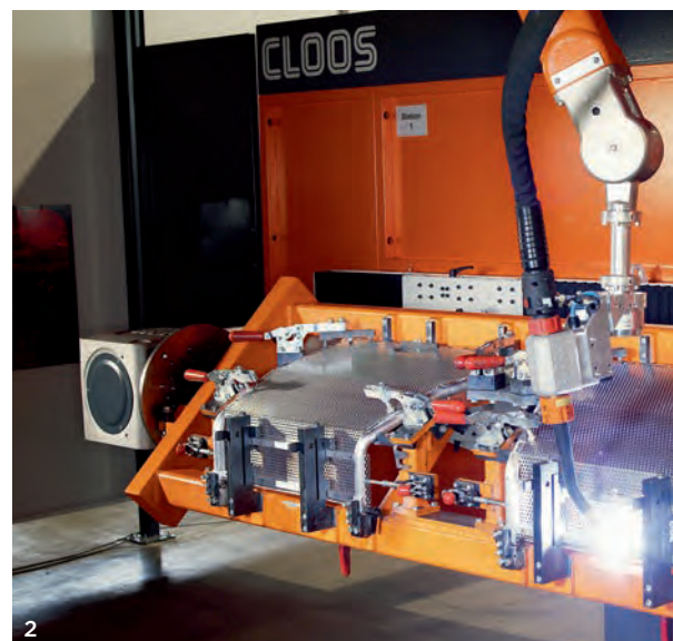
1 Das Multi-Lastenfahrzeug zeichnet sich durch seinen kompakten Aufbau aus. 2 Die Roboteranlage zeichnet sich durch maximale Flexibilität aus, so dass ein Wechsel zwischen unterschiedlichen Bauteilen schnell möglich ist.
