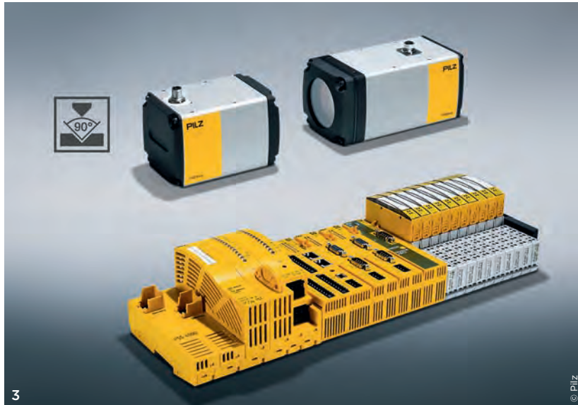
3 Die kamerabasierenden Schutzsysteme PSENvp sind mitfahrende Schutzvorrichtungen. Sie überwachen optisch den gesamten Abkantprozess. Installiert an der Oberwange erkennen sie selbst kleinste Fremdkörper im Schutzfeld zwischen Sende- und Empfängereinheit. 4 Mit dem Modul zur Biegemessung werden verwertbare Bilddaten vom kamerabasierenden Schutzsystem PSENvp 2 direkt an die Pressensteuerung weitergeleitet und dadurch ein effizienter Abkantprozess gewährleistet. Die Anzeige des Biegemesswertes erscheint dabei auf der Bedienoberfläche der Maschine. Sowohl die aufwändige Messung der Winkel per Hand als auch teure Wegmesssysteme entfallen.
