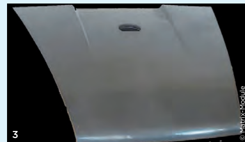
1 „Vogelperspektive“: Einzelelement der Necto-Struktur. 2 Das Necto-Sandwich von unten 3 Reko-Motorhaube eines klassischen Sportwagens mit GFK-Decke auf Aluminiumstruktur: 6 statt 15 Kilogramm.
