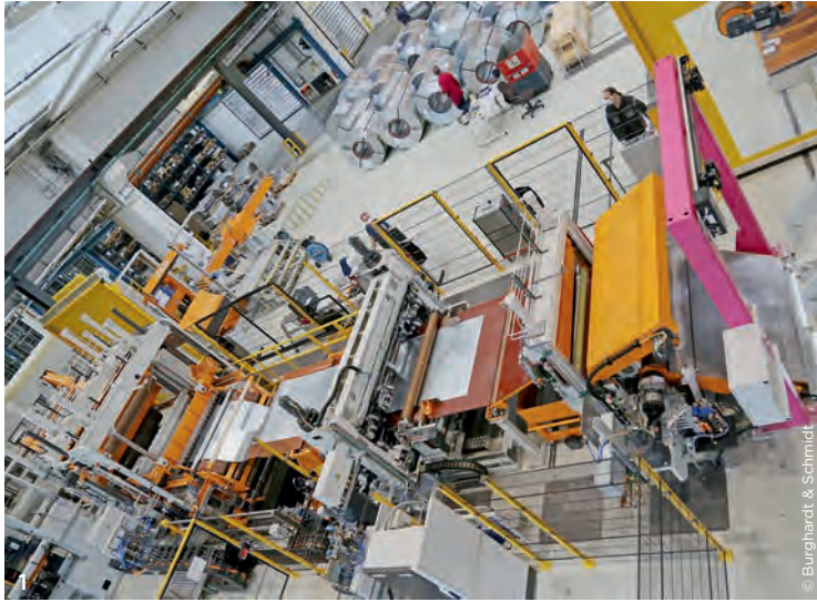
1 Die gesamte Längsteilanlage von oben 2 Auch wenn hier nur drei Streifen erzeugt werden, sieben wären möglich – weit mehr als branchenüblich.
