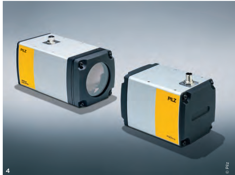
3 Die kamerabasierenden Schutzsysteme PSENvp sind mitfahrende Schutzvorrichtungen. Sie überwachen optisch den gesamten Abkantprozess. Installiert an der Oberwange erkennen sie selbst kleinste Fremdkörper im Schutzfeld zwischen Sende- und Empfängereinheit. 4 Mit dem Modul zur Biegemessung werden verwertbare Bilddaten vom kamerabasierenden Schutzsystem PSENvp 2 direkt an die Pressensteuerung weitergeleitet und dadurch ein effizienter Abkantprozess gewährleistet. Die Anzeige des Biegemesswertes erscheint dabei auf der Bedienoberfläche der Maschine. Sowohl die aufwändige Messung der Winkel per Hand als auch teure Wegmesssysteme entfallen.
