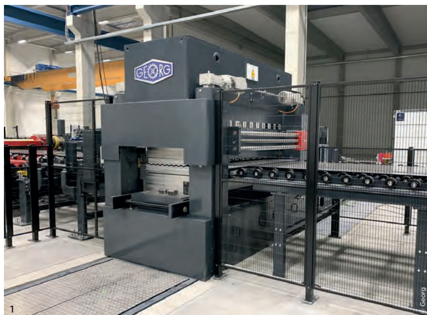
1 Für die Hochleistungs-Richtmaschine hat Georg drei Richtkassetten geliefert, die an die Eigenschaften der unterschiedlichen Werkstoffe angepasst sind. 2 Die hochautomatisierte Besäumschere mit der „Georg Shimless Tooling“ Technologie verringert die Stillstandszeit bei jedem Messerwechsel deutlich.
