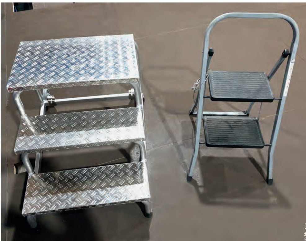
Der Maschinentritt von Hymer besteht aus Aluminium und ist dadurch leicht. Anti-Rutschkappen an den Rohrenden verhindern das Verrutschen. Rechts zum Vergleich der vom Maschinenlieferanten mitgelieferte Tritt.
