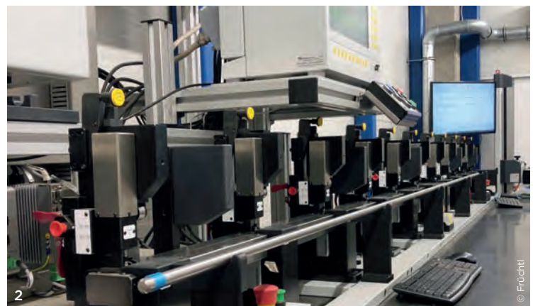
2 Stainless Früchtl könne Geradheit und Rundheit von Stangenmaterial mit „bisher unerreichter“ Genauigkeit messen, so der Hersteller.
