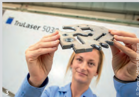
3 Eine Mitarbeiterin prüft ein Bauteil, das sie mit Hilfe der Trumpp-Technologie EdgeLine Bevel angefast hat.
