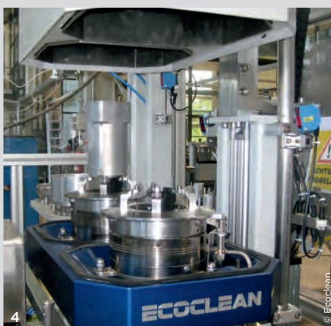
4 Trockenreinigungsverfahren wie beispielsweise die Vakuump-Luft-Reinigung lassen sich unter anderem in Montagelinien integrieren und zur Entpulverung additiv gefertigter Teile einsetzen.
