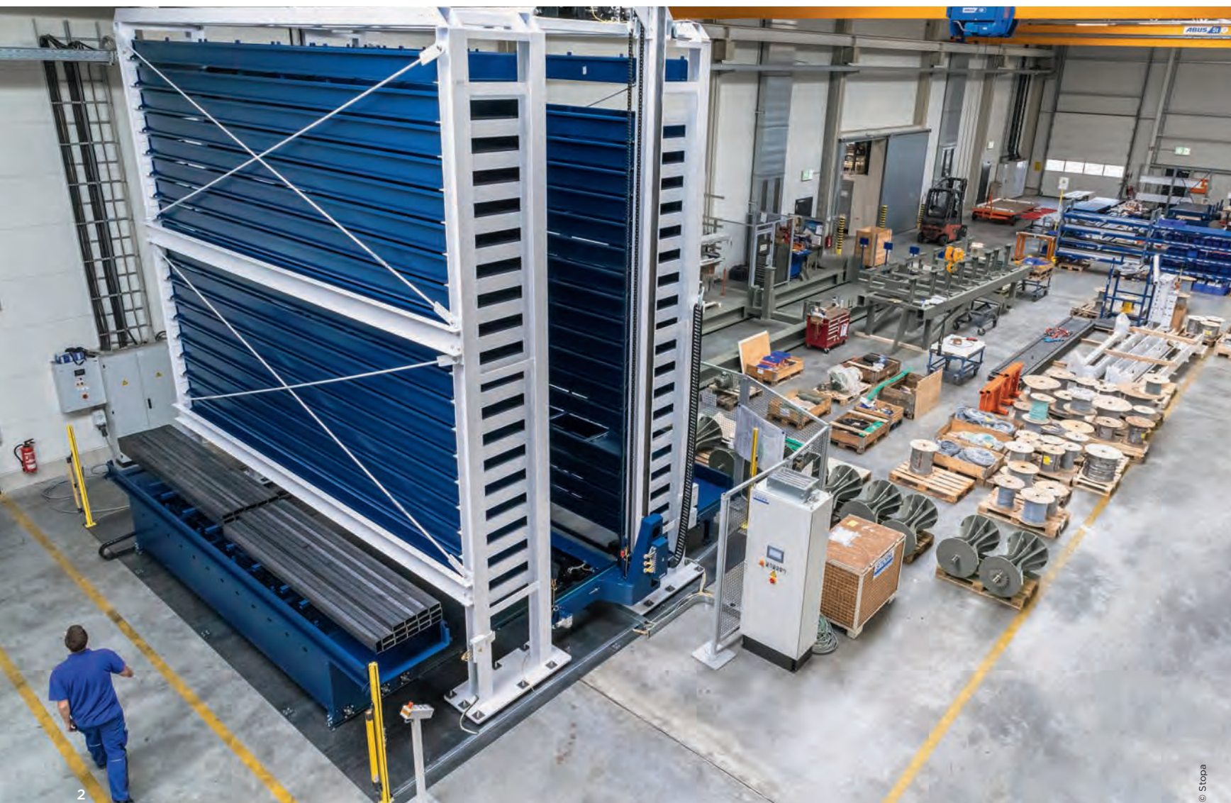
1 Das automatische Stopa Compact II Blech- lager fungiert als internes Logistikzentrum.
