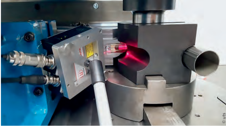
Laser-Liniensensor zur Erfassung der Rohrkontur, platziert hinter der Faltenglätteraufnahme und der Biegeform mit Projektion auf die Rohroberfläche durch Aussparungen in den Werkzeugen
