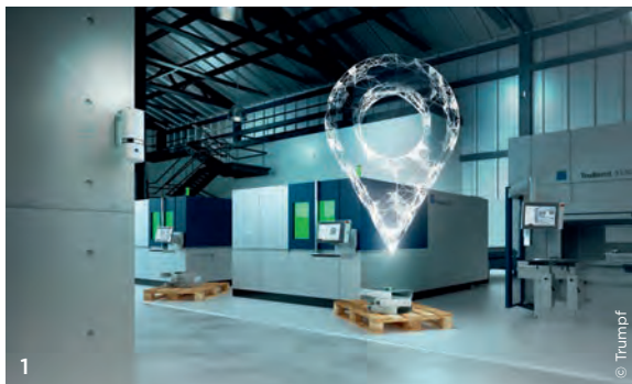
1 Empfänger, auch Satelliten genannt, orten durch die Funkwellen der Tags die Position auf 10 bis 30 cm genau.
