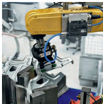
38_ Leichtbaugreifer hält Stanzbiegeteile sicher zum Schweißen.
