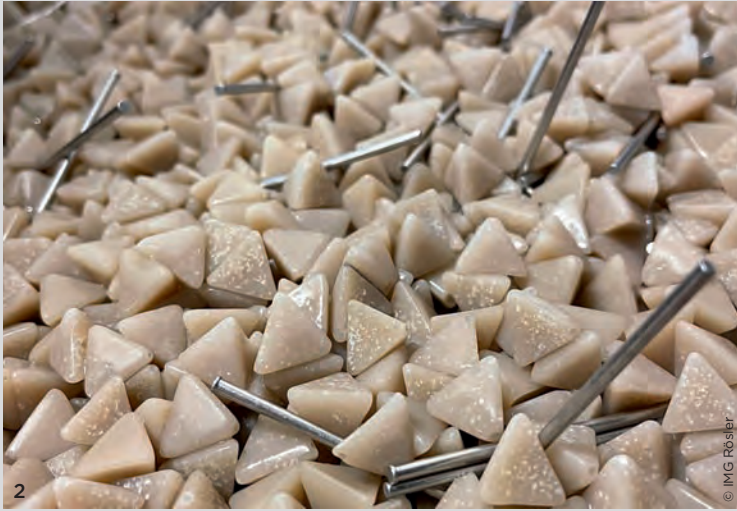
1 Die patentierte Form des innovativen MultiShape-Keramiksleifkörpers wirkt einerseits Verklebungen entgegen. Andererseits macht sie die Bearbeitung komplexer Bauteile prozesssicherer, effizienter sowie nachhaltiger und eröffnet neue Anwendungsfelder bei Teilen, die bisher nicht oder nur sehr aufwendig in Gleitschliffverfahren zu bearbeiten waren. 2 Bei der Bearbeitung von Werkstücken mit Kunststoffschleifkörpern erhöht die neue schaumfreie N-Variante die Reproduzierbarkeit des Ergebnisses und verbessert die Wirtschaftlichkeit, Produktivität und Nachhaltigkeit. 3 Das einfach zu dosierende und lebensmittelechte Additiv Anti-Dust bindet bei der Trocknung mit Naturgranulaten wie Maisschrot entstehenden Staub effektiv. Resultat sind sauberere Werkstücke und Produktionsumgebungen sowie ein angenehmeres Arbeitsumfeld.
