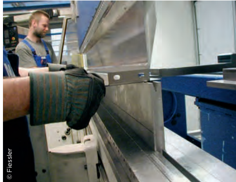
Das Gesenkbiegepressen-Sicherheitssystem AKAS 3P gewährt laut Fiessler volle Sicherheit sowohl im Flach- als auch Kastenbiegemodus.
