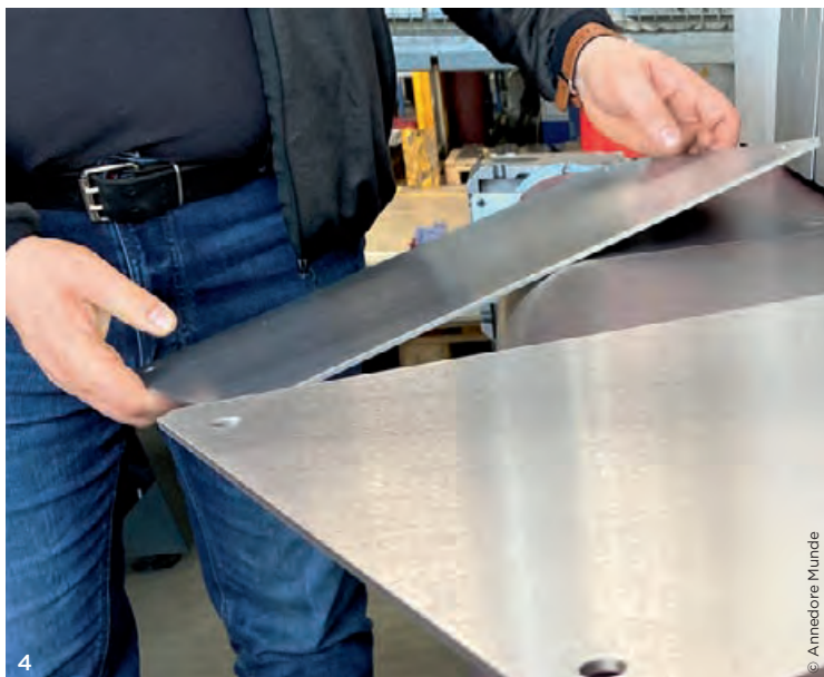
4 Die Trockenschleiftechnik war für Sturm Blechverarbeitung neu, denn bisher wurde Nassschleifen eingesetzt. 5 Auf dem Powergrip-Gurt der SMB-L werden die Teile bei der Bearbeitung dank der hohen Haftkraft ohne Magnet oder Vakuum fixiert.
