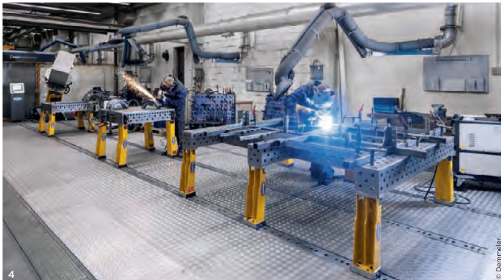
4 Mit dem Demmeler-Schienensystem können die Arbeitsplätze nach Bedarf flexibel verändern, zum Beispiel in einen großen Arbeitsplatz oder auch mehrere kleine.
