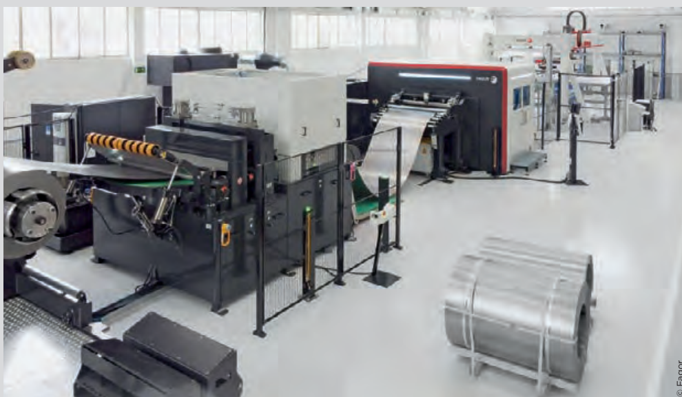
Wenn die Stückzahlen überschaubar sind, bieten Laser-Blanking-Anlagen gegenüber Pressen erhebliche Vorteile.
