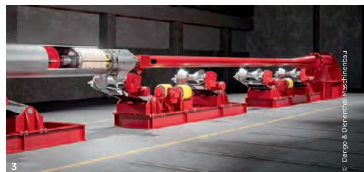
1 Die erste Maschine, die D&D zurzeit fertigt, richtet und expandiert die Rohrenden. 2 Beim Sizen der Rohrenden misst der Zirkular-Laser zunächst die Innenkontur, anschließend setzen die Spreizbacken an. 3 Beim Full-Body-Sizen wird das Rohr auf der gesamten Länge bearbeitet.
