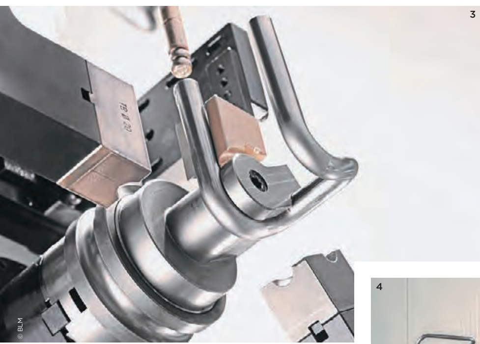
1 Einfacher, schneller und kostengünstiger sind die Rohre mit der vollelektrischen E-Turn 40 herzustellen. 2 Von der Step-Datei zum fertigen Biegeteil ist es nur ein kleiner Schritt. 3 Die E-Turn 40 biegt faltenfrei mit und ohne Dorn. 4 Mit der E-Turn 40 kann Meiko komplexere Teile ebenfalls selbst herstellen, auch aus Vollmaterial, eckigen und ovalen Rohren. 5 Zudem ist die Qualität besser als früher.
