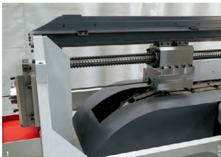
1 Die auf einer Kugelumlaufspindel montierte Einziehzange fördert einen neuen Draht in die Maschine, der anschließend vom Raupenzug gefasst wird.
