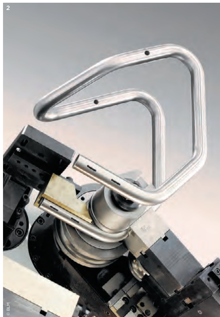
1 Einfacher, schneller und kostengünstiger sind die Rohre mit der vollelektrischen E-Turn 40 herzustellen. 2 Von der Step-Datei zum fertigen Biegeteil ist es nur ein kleiner Schritt. 3 Die E-Turn 40 biegt faltenfrei mit und ohne Dorn. 4 Mit der E-Turn 40 kann Meiko komplexere Teile ebenfalls selbst herstellen, auch aus Vollmaterial, eckigen und ovalen Rohren. 5 Zudem ist die Qualität besser als früher.
