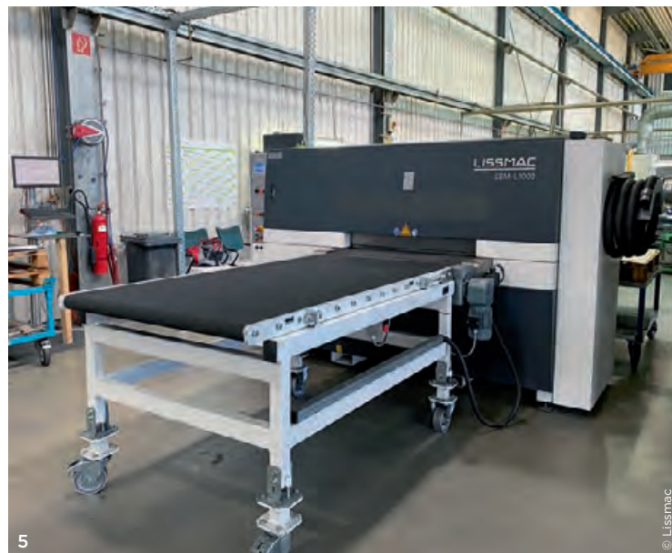
4 Die Trockenschleiftechnik war für Sturm Blechverarbeitung neu, denn bisher wurde Nassschleifen eingesetzt. 5 Auf dem Powergrip-Gurt der SMB-L werden die Teile bei der Bearbeitung dank der hohen Haftkraft ohne Magnet oder Vakuum fixiert.
