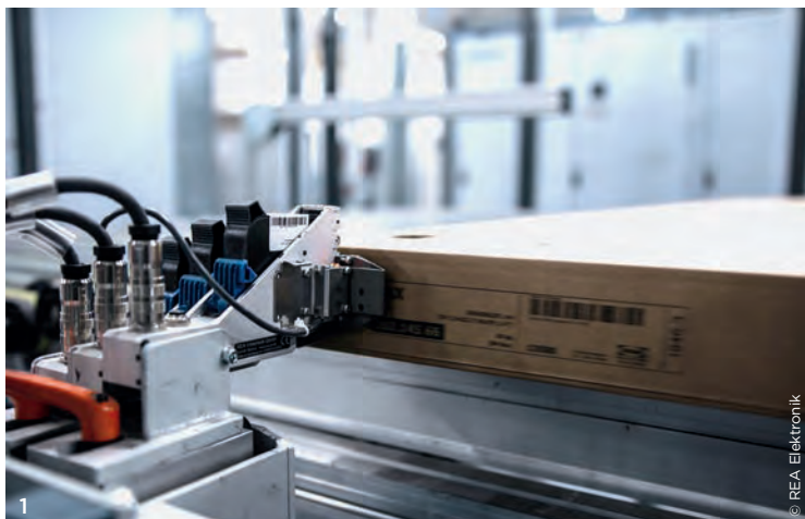
1 Kartonagebeschriftung mit REA Jet HR 2 Für den flexiblen und mobilen Einsatz in Produktion, Labor, Wareneingang und Qualitätssicherung ist der neue REA-Verifier VeriMax Mobile konzipiert.
