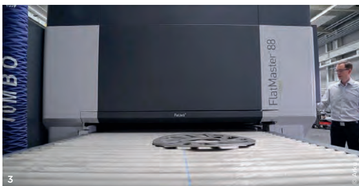
1 Teilerichtmaschine Arku FlatMaster mit Ebenheitsmessgerät FlatJack 2 Vor dem Richten: Welligkeit zentimeterweise 3 Richten in der 17-Rollen-Kassette 4 Mehr als Augenmaß: Der FlatJack fährt zur Ebenheitskontrolle aus.
