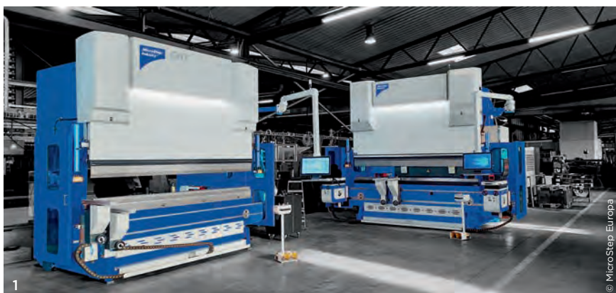
1 Abkantpressen von MicroStep Industry können nicht nur exakt auf die Bedürfnisse des Anwenders ausgelegt werden, sondern sparen dank innovativer Technologien im Ergebnis jede Menge Zeit, Ausschuss und Energie. 2 Das Produktspektrum reicht vom kompakten Einsteigermodell bis zur individuell auslegbaren Hightech-Pressen, die hinsichtlich Biegekraft und Biegelänge exakt auf die Bedürfnisse des Kunden ausgelegt werden kann. Auch Tandem- und Tridemlösungen sind problemlos realisierbar.
