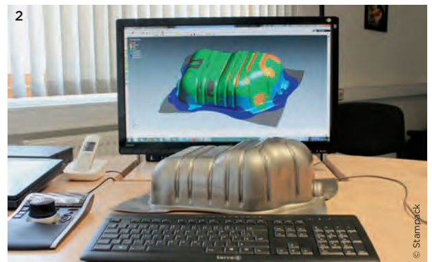
1 Stampack kompensiert das berechnete Aufsprungverhalten ins Werkzeug und entfernt dabei entstandene Hinterschnitte. 2 Rissfrei gezogene Schalen beim ersten Pressengang dank Optimierung in der Umformsimulation. Der Abgleich von Simulation und Realität schafft Vertrauen.
