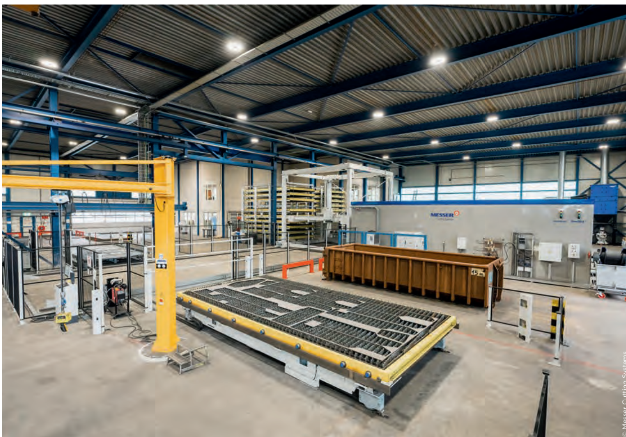
„Solutions Beyond Machines“ bei Joop van Zanten (Niederlande) mit Messer Cutting Systems PowerBlade mit Faserlaser-Technologie und OmniMat mit Plasma-Fasenschneiden, OmniFab-Digitalisierungslösung, OmniWin CAD-CAM-Software und Material-Handling-System.
