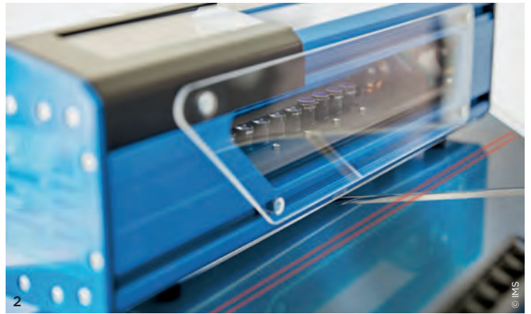
1 Für die Detektion der Planheit einer Bandbreite von 2 m benutzt man bereits 100 dieser High-Tech-Kameras 2 Prinzipieller Aufbau der Camera-Cluster-Systems (CCS)
