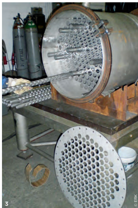
1 Querschnitte durch Strukturrohre 2 Überprüfung einer Dreierstruktur, wie sie die DIN beispielgebend vorsieht, durch Prof. Udo Hellwig und ERK-Produktionsleiter Jörg Rickert 3 Um den Faktor zwei erhöhter Wärmeübergang ohne Druckverlusthöhung: Durchführung DIN-gemäß strukturierter Rohre durch den Rohrboden eines prototypischen Rohrbündel-Wärmeübertragers
