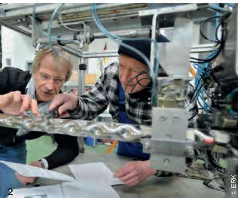
1 Querschnitte durch Strukturrohre 2 Überprüfung einer Dreierstruktur, wie sie die DIN beispielgebend vorsieht, durch Prof. Udo Hellwig und ERK-Produktionsleiter Jörg Rickert 3 Um den Faktor zwei erhöhter Wärmeübergang ohne Druckverlusthöhung: Durchführung DIN-gemäß strukturierter Rohre durch den Rohrboden eines prototypischen Rohrbündel-Wärmeübertragers
