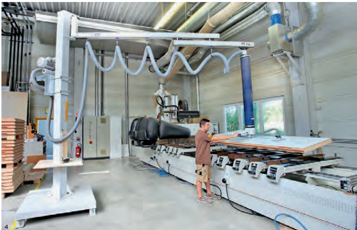
4 Der Teleskoparm erleichtert das Beladen von CNC-Maschinen, indem der Ausleger um einen Meter verlängert werden kann.
