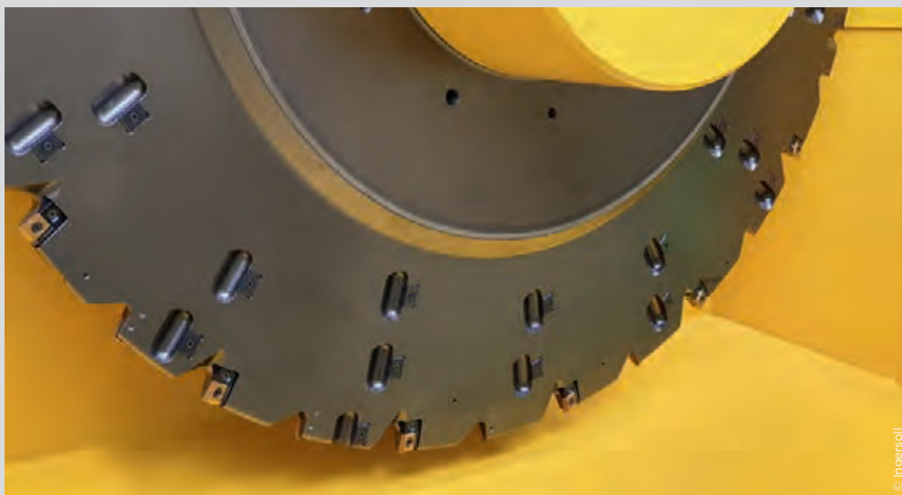
Die zur Schweißnahtvorbereitung eingesetzten Scheibenfräser von Ingersoll haben Durchmesser zwischen 850 und 1060 Millimetern. Bestückt sind sie mit unterschiedlichen Schneidplatten für Kopf und Flanken des Werkzeugs.
