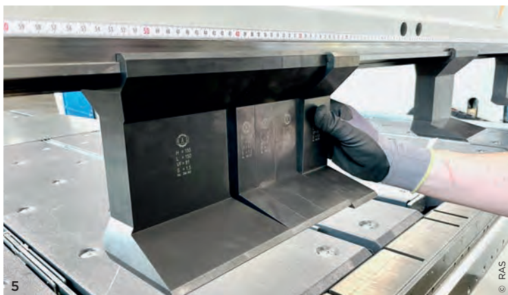
5 Ein Werkzeugwechsel lässt sich in weniger als einer Minute erledigen – wichtig bei 20 bis 30 Wechseln pro Tag.
