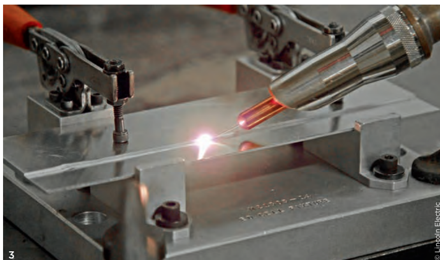
1 Additive Fertigung eines Kupferbauteils mit Hilfe eines blauen Diodenlasers 2 Pulverbasierende Laserbeschichtung einer Bremscheibe 3 Aluminiumschweißen mit Heißdraht
