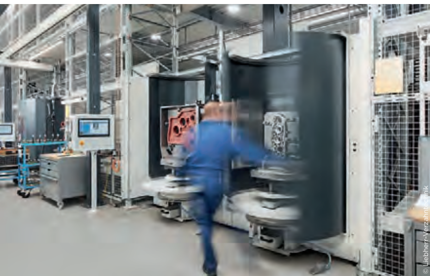
Rüstplatz und Steuerung für die Palettenhandhabungssysteme
