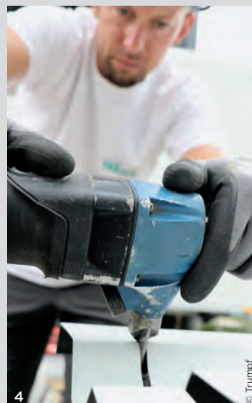
3 Für Längsschnitte in Dünnblech setzt Mitarbeiter Radomir Krivokuca am liebsten die Akku-Schlitzscheren TruTool C160 ein. Mit ihr schafft er eine Arbeitsgeschwindigkeit von bis zu neun Metern pro Minute.
