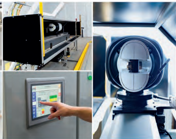
1 Bei drei Laser-Radar-Sensoren kann das Band mit 140 mm/s laufen. 2 Sobald sich das Fahrzeug innerhalb des Systems befindet, bewegen sich die Laser-Radar-Sensoren mittels Linearführungen synchron zur Geschwindigkeit der Fertigungslinie und können so die Spalt- und Bündigkeitsmessung an vorprogrammierten Bereichen durchführen.
