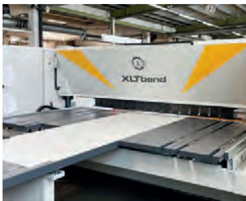
20_Schwenkbiegen großer Bleche spart Kosten dank Einmannbedienung.
