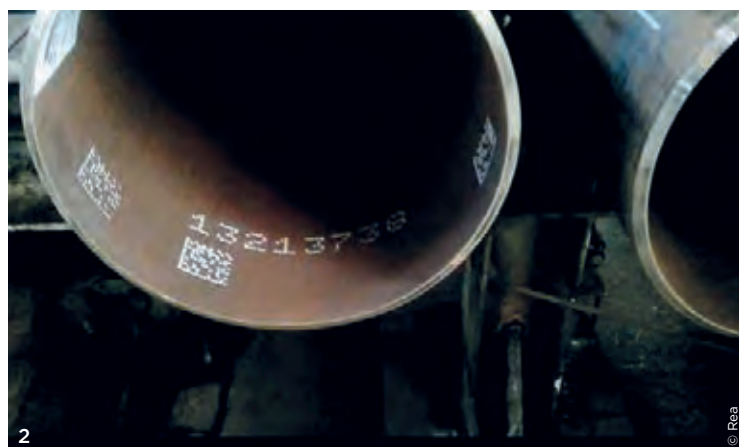
1 Das „Nass-in-Nass“-Druckverfahren mit dem Tintenstrahldrucker Rea Jet HR entwickelt leistungsstarke und kontrastreiche Beschriftungen und ermöglicht den Verzicht auf Etiketten.
