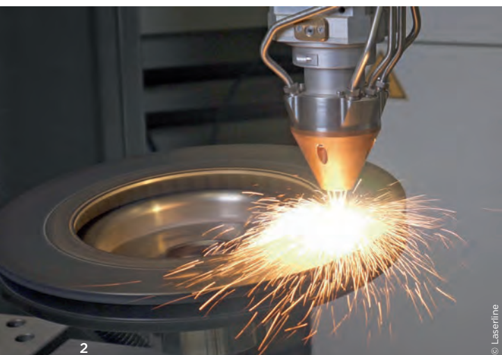
1 Additive Fertigung eines Kupferbauteils mit Hilfe eines blauen Diodenlasers 2 Pulverbasierende Laserbeschichtung einer Bremscheibe 3 Aluminiumschweißen mit Heißdraht
