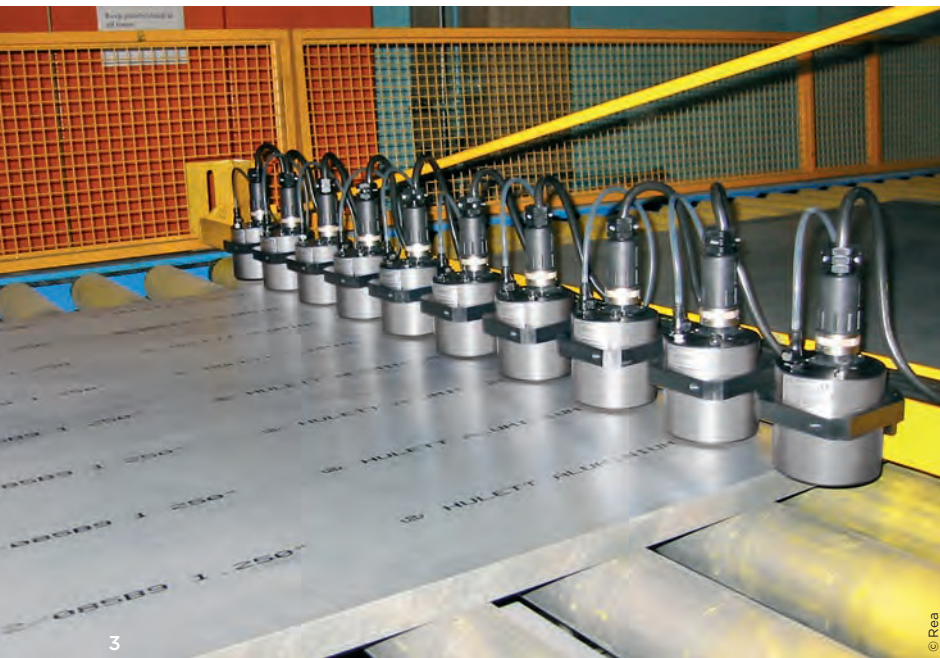
3 Mit zehn Schreibköpfen kennzeichnet ein Rea Jet DOD 2.0 eine Aluminiumplatte.
