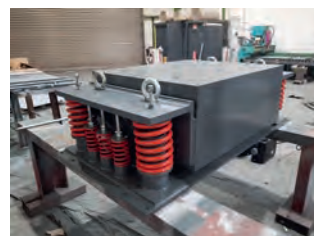
Schwingungstilger Dämpfung von Brückenschwingungen Deckenschwingungen
