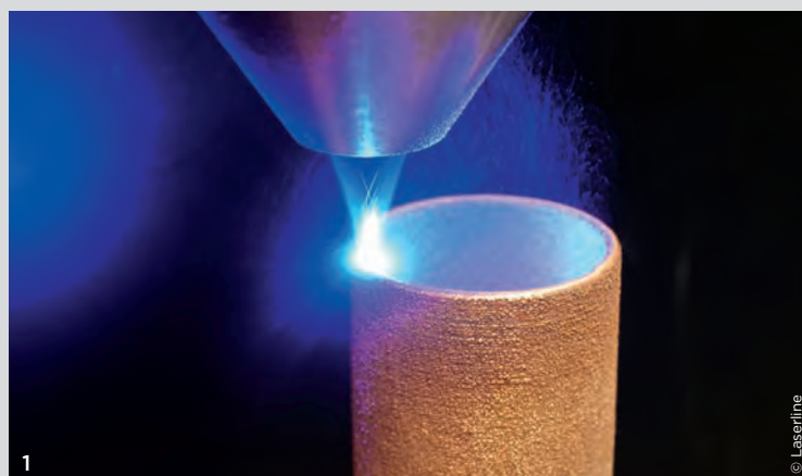
1 Blaue Laser eignen sich besonders gut für die additive Fertigung mit Kupfer. 2 Um Hochleistungs-Weißlicht mit über 100.000 Lumen bei Leuchtdichten von mehr als 1.000 cd/mm 2 zu erzeugen, wird ein rotierender Ring aus Phosphor (Phosphor Wheel) von einem blauen Diodenlaser (450 nm Wellenlänge) bestrahlt.
