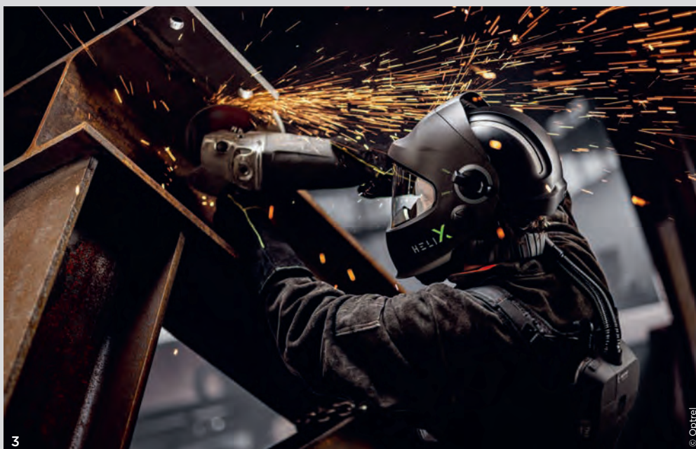
1 Der Helix besitzt ein ADF (Automatic Darkening Filter)
