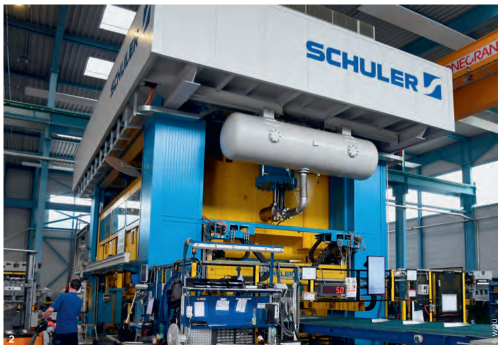
2 Auf einer Schuler-Presse, die bei 16.000 kN Presskraft und 7,3 m Tischlänge mit der Twinservo-Technologie arbeitet, werden die Längsträger für einen europäischen Hochvolumentenhersteller gefertigt.
