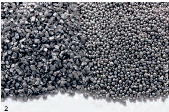
1 In den Induktionsöfen wird Edelstahl geschmolzen und anschließend verdüst dabei entsteht das kugelige Chronital. 2 Das kantige Grittall (links) und das kugelige Chronital im Vergleich.
