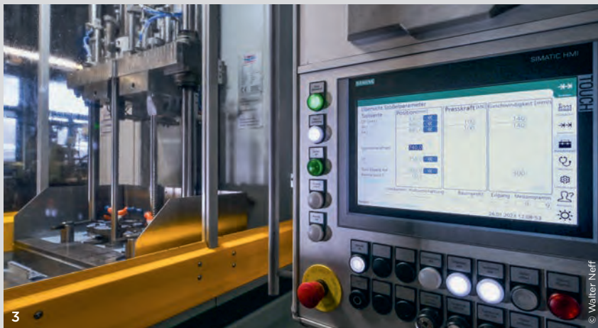
2 Die neue Hydraulikpresse wurde mit einer neuen Schutzvorrichtung, integrierten Regelungsfunktionen und einer servogesteuerten Pumpe konzipiert. 3 Über das übersichtliche Interface auf dem Simatic-HMI-Panel können die Bediener Parameter einstellen sowie die Presskraft und die Geschwindigkeit überwachen.
