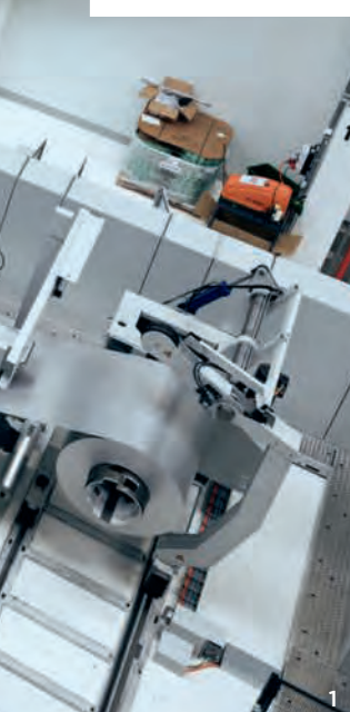
1 Die Laser Blanking Line im Smart Press Shop in Halle/Saale, die Messsysteme von Amepa sind hinter der Richtmaschine installiert. 2 Die Sensoren sind auf motorgesteuerte Traversen montiert und können über die Breite des Bandes verfahren werden. 3 Die Messsysteme sind so kompakt, dass ein geringer Bauraum ausreicht.
