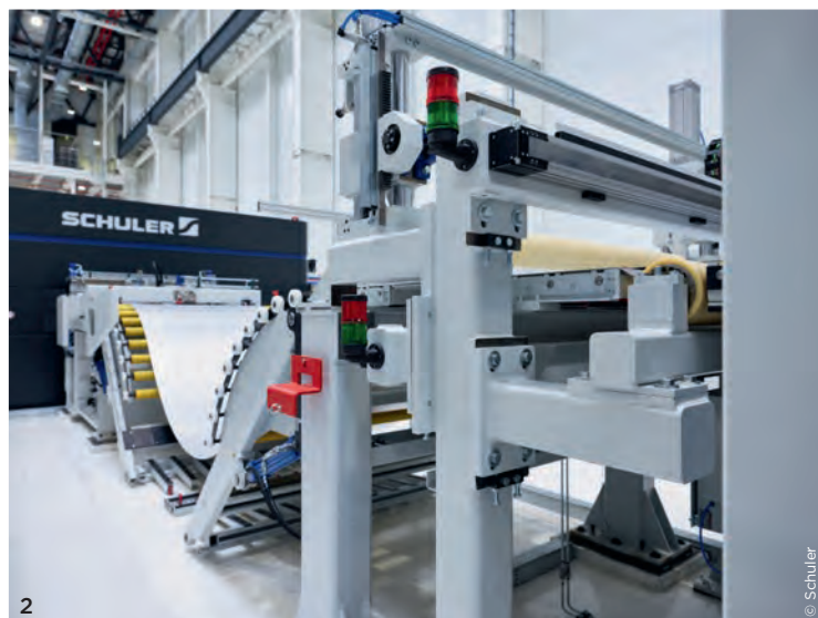
1 Die Laser Blanking Line im Smart Press Shop in Halle/Saale, die Messsysteme von Amepa sind hinter der Richtmaschine installiert. 2 Die Sensoren sind auf motorgesteuerte Traversen montiert und können über die Breite des Bandes verfahren werden. 3 Die Messsysteme sind so kompakt, dass ein geringer Bauraum ausreicht.
