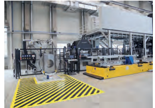
88_Mehr als nur eine Presse mit 10 Meganeutron – auch die Peripherie muss stimmen.
