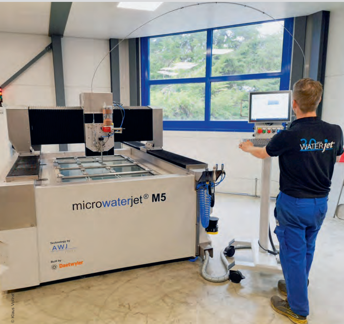
Die neue Mikro-Wasserstrahlschneidmaschine M5 von Waterjet kann Tafeln im Handelsformat 2.000 x 1.000 mm verarbeiten.
