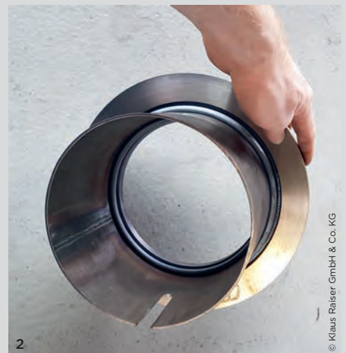
1 Gerade im Automobilbau lassen sich Bauteile wie ... 2 ... Komponenten für Bremsen durch Reibschweißen kostengünstig und schnell fertigen.
