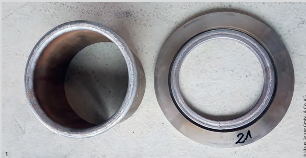
1 Gerade im Automobilbau lassen sich Bauteile wie ... 2 ... Komponenten für Bremsen durch Reibschweißen kostengünstig und schnell fertigen.
