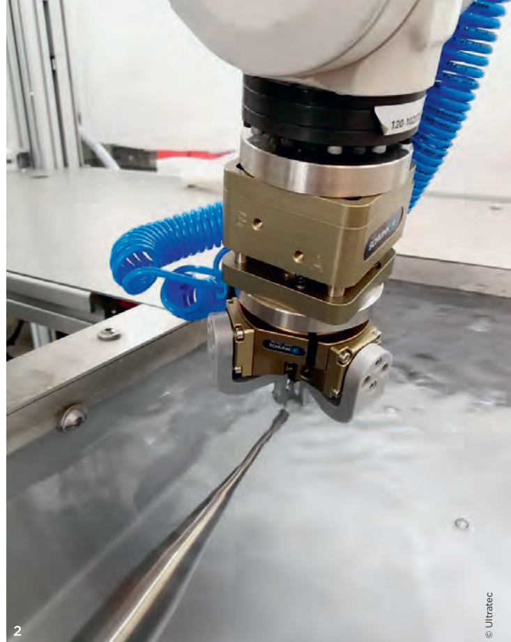
2 Das Ultraschallentgraten erfolgt in einem Prozesswasserbecken, in die Bauteile an die hochfrequente Ultraschall-Sonotrode geführt werden.
