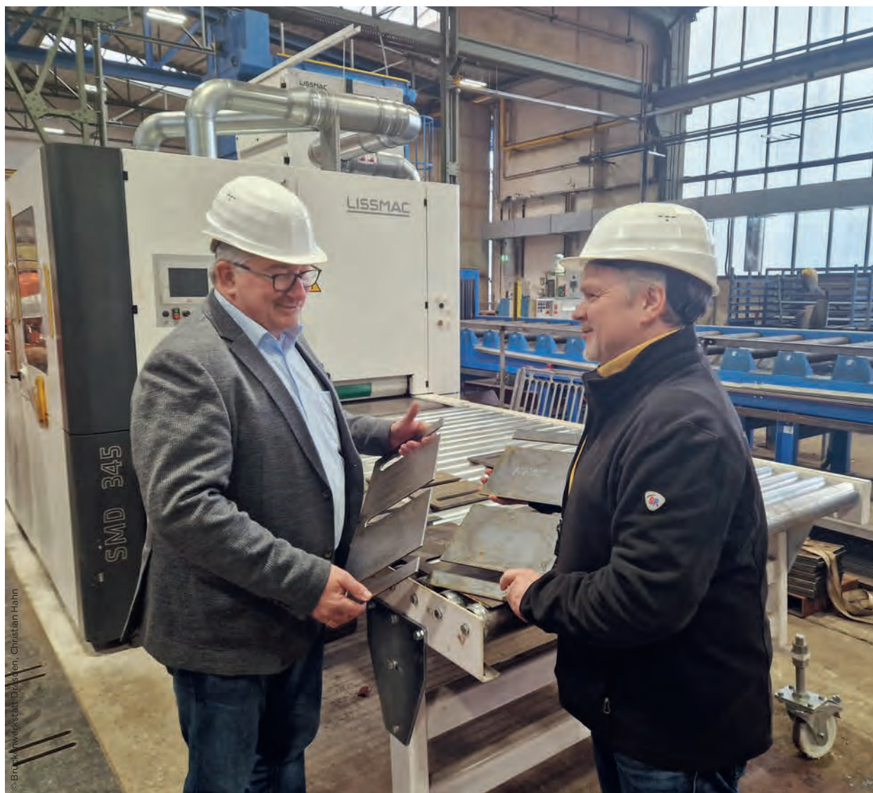
Roland Möbius (rechts), zuständig für den Bereich Zuschnitt in der Brückenwerkstatt Dresden, und Dirk Schürstedt, Gebietsverkaufsleiter Metal Processing bei Lissmac, prüfen das Ergebnis des Kantenverrundungsprozesses
