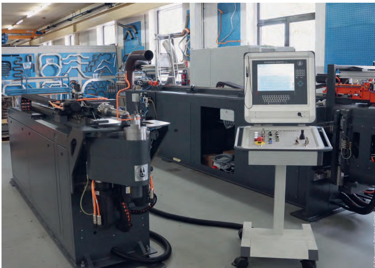
Die vollelektrische Biegemaschine CNC 25 Orbital von Schwarze-Robitec ist speziell für das Biegen von Stromschienen ausgelegt.
