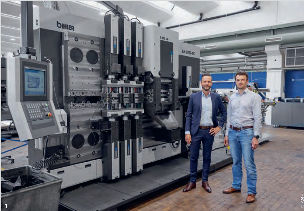
1 Marc Walter (rechts): „Ohne unser „Plug & Produce“-Prinzip mit maschinenseitig eingebauten AMF-Nullpunktspannsystemen und modularen Linearwerkzeugen hätten wir den Auftrag nicht bekommen.“ Links Michael Nau von AMF
