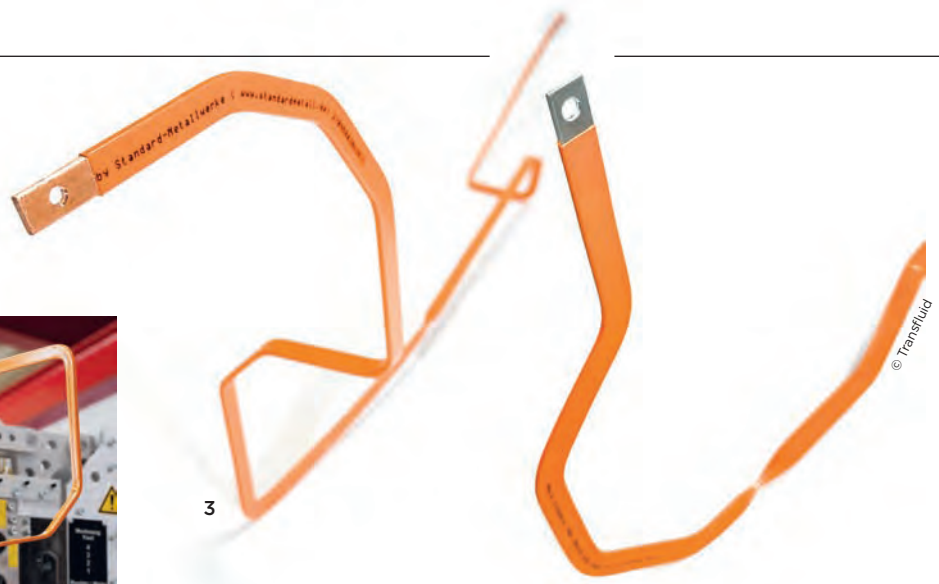
3 Sensible Busbars, die aufgrund der geringen Eigenstabilität eine Herausforderung beim Handling, Biegen und Positionieren darstellen, können jetzt zuverlässig und wiederholgenau gebogen werden.
