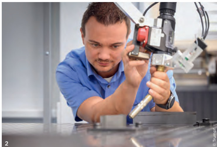
2 Mit Smart Seam Tracking lässt sich der Schweißroboter innerhalb weniger Sekunden programmieren, selbst bei komplexen Bauteilen. Das entlastet Mitarbeiter und wirkt dem Fachkräftemangel entgegen. 3 Auch bei EWM gehören Cobots und Roboterschweißzellen sowie neue Automatisierungslösungen zu den „heißen“ Themen. 4 Das Fraunhofer IWS will mit neuer Lösung Metalle auch unter der Meeresoberfläche per Laser bearbeiten.
