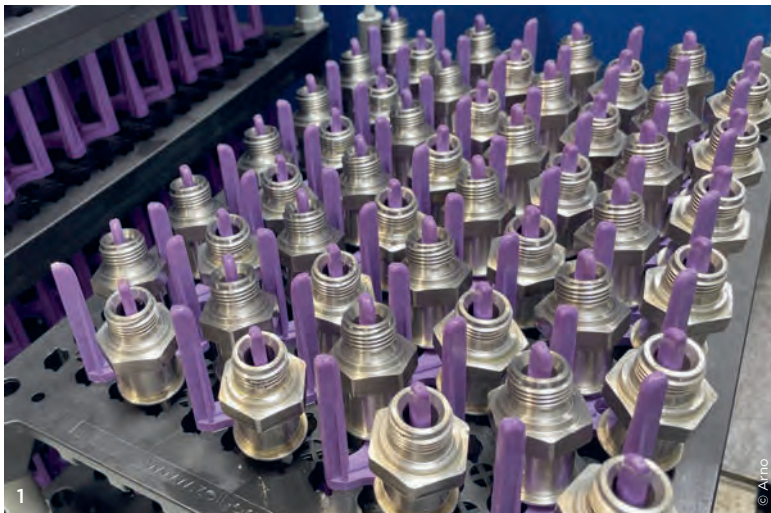
1 Arno Werkzeuge unterstützt Schuhmacher mit vielen Werkzeugen. Darunter sind Bohrwerkzeuge, Drehwerkzeuge, Abstechwerkzeuge sowie Werkzeugwechselsysteme und Halter. Die Serien an Drehteilen reichen von 25 Stück bis zu mehreren Millionen im Jahr. 2 Die Experten für Drehteile von Schuhmacher bearbeiten jegliche Werkstoffe von Kunststoff über Aluminium bis zu allen Sorten von Stahl.
