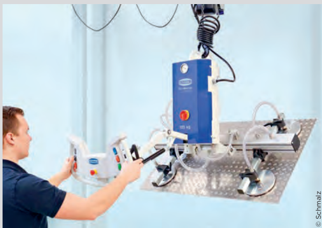
Fachkräfte bewegen große und flächige Werkstücke bis 750 Kilogramm mit dem VacuMaster Comfort sehr energiesparend.
