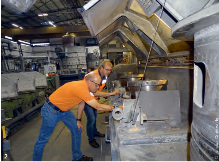
1 Mit Bison-A und -B innen und außen beschichtete HM-Ziehsteine 2 Endkontrolle der Ziehsteineinstellungen in einer computergesteuerten Mehrfachziehmaschine der Neckar Drahtwerke in Erbach durch Herrn F. Auer (Produktionsleiter [im Vordergrund]) und Herrn M. Ulrich (Werksleiter) 3 Drahtfertigung mittels einer Einfachziehmaschine
