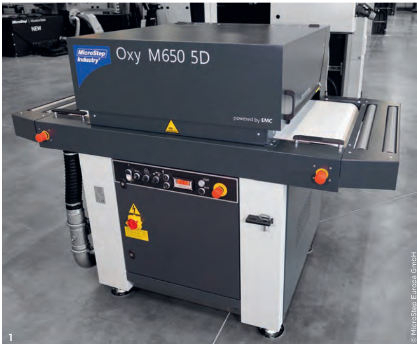
1 Die kompakte Anlage ermöglicht eine qualitativ hochwertige Oberflächenbearbeitung von Bauteilen verschiedener Materialien, beispielsweise das Entgraten, Schleifen und Kantenverrunden von Blechen.
