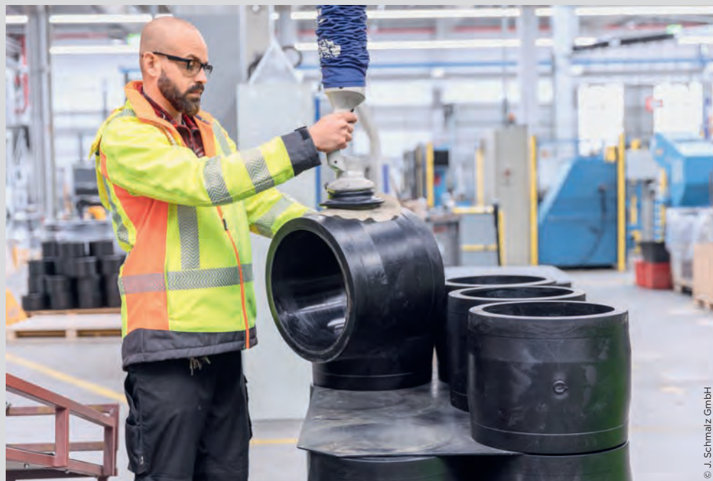
Die Muffe hält der Rundsauggreifer trotz gewölbter Oberfläche – dank Silikon-Schürze.
