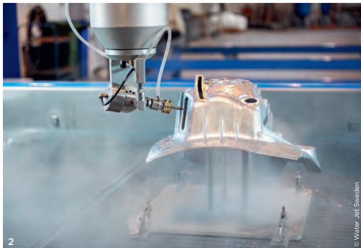
1 Hell setzt sich optisch der Ring ab, der die Schaufeln des ersten Laufrades des Verdichters stabilisiert. 2 Die Voll-3D-Schneidemaschine (0° bis 120°) FiveX Ultra mit Mikroschneidkopf wurde für die Abarbeitung hochpräziser Schnittaufgaben entwickelt. 3 Feinabstimmung der Parameter im Demo-Center von Water-Jet-Sweden in Ronneby, Schweden.
