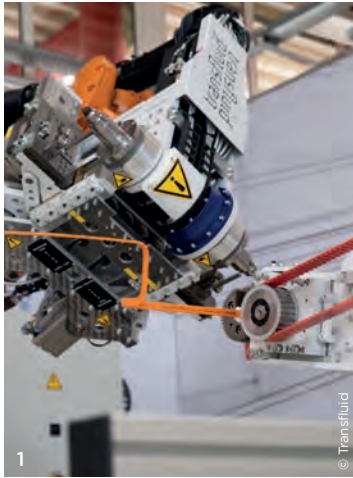
1 Der rechts-links biegende Biegekopf ermöglicht eine maximale Biegefreiheit für komplexe Biegegeometrien.
