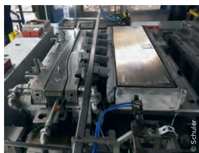
Bei dem neuen Verfahren wird das Leichtmetall in kürzester Zeit erhitzt (rechts), umgeformt und gleichzeitig gehärtet.
