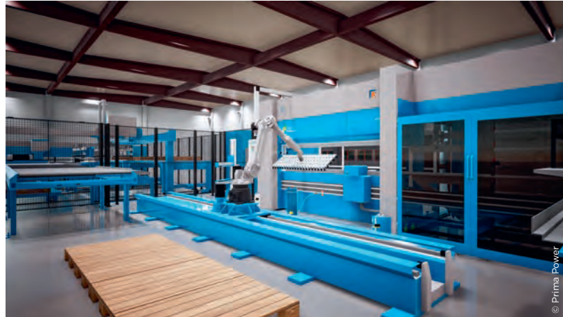
Die eP Genius des auf der Blechexpo vorgestellten Systems Prima Power ist mit einem anthropomorphen Roboter für völlig unbemannte Be- und Entladevorgänge integriert.
