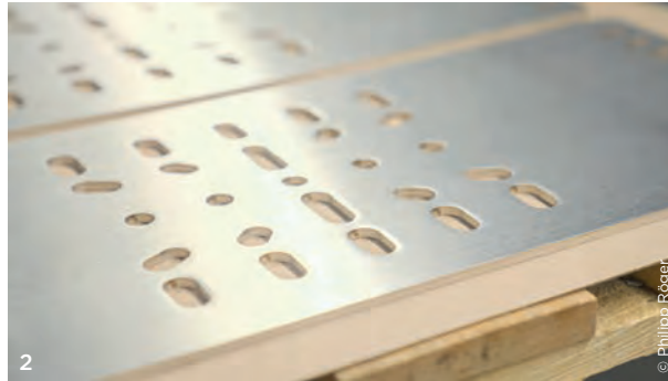
1+2 Typische Teile bei Reiff Umformtechnik vor und nach der Entgratung.
