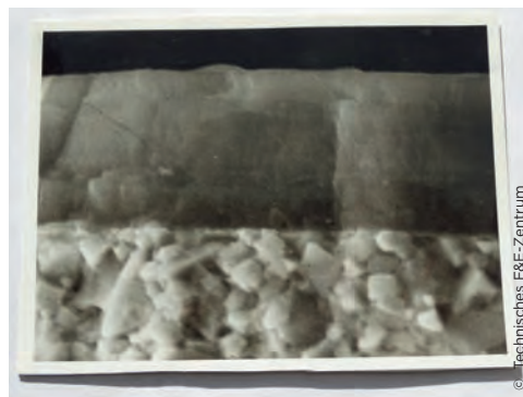
Deutlicher Unterschied: feine Hartstoffbeschichtung auf kristallinem Hartmetall
