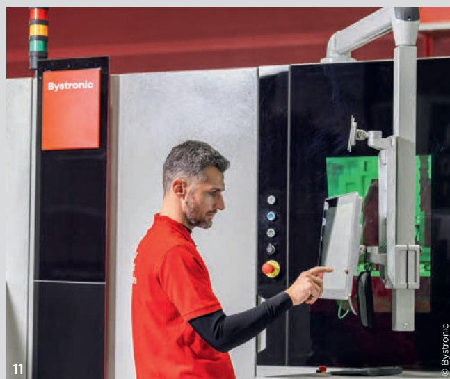
10 Der automatisierte Entladespeicher der Bytube Star 330 erleichtert die Intralogistik. 11 Mit der Bedienoberfläche BySoft Cell Control Tube bringt Bystronic alle Funktionen rund um das Laserschneiden von Rohren und Profilen auf einen Touchscreen.
