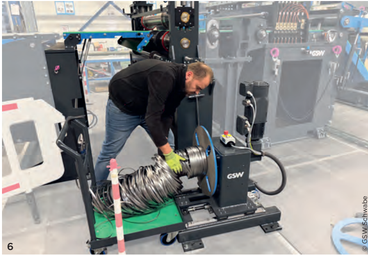
6 Der Saumschrott wird drehmomentgesteuert aufgewickelt, die Haspel ist konisch, so dass das Abziehen des Saumschrottcoils einfach ist. Da ein Kran nicht nutzbar war, dient ein passend konstruierter Wagen dem Abtransport. Im Hintergrund ist die Besäumschere zu sehen. 7 Der Bandeinlauf in den Walzenvorschub: Unter den grünen Abdeckungsstreifen sind die Präzisionskugellager zu sehen, die das einlaufende Blech für die Schere präzise ausrichten.
