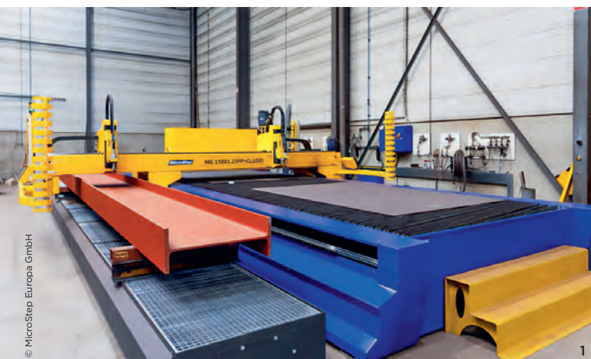
1 PariMetal entschied sich für eine Plasmaschneidanlage der MG-Baureihe von MicroStep – die 15 m lange und 2,5 m breite Anlage verfügt über einen Ausleger an der Portalbrücke, der die Bearbeitung von Rohren mit einem Durchmesser von bis zu 1.000 mm ermöglicht. 2 Erhebliche Zeitersparnisse durch das neue Plasmasystem: Löcher, die früher aufwändig manuell nachträglich eingebracht werden mussten, übernimmt nun die Anlage.
