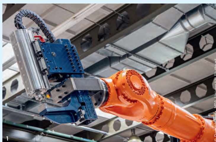
1 Die robotergeführte Rührreibschweißzange „Steppwelder“ im Einsatz an einem 6-Achs-Industrieroboter.
