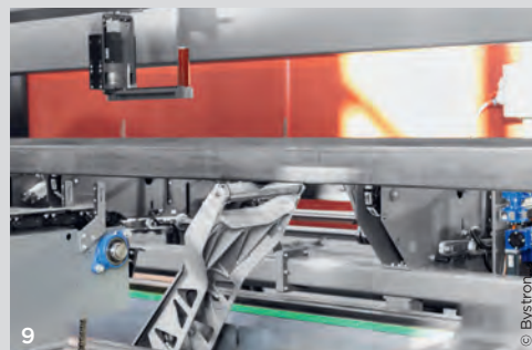
6 Der Schneidkopf der Bytube Star 330 bringt die Leistung eines 10 KW Lasers auf die Bauteile.
