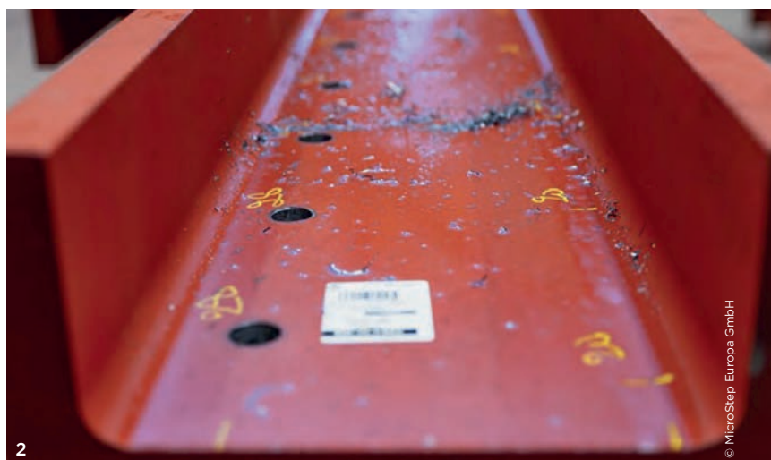
1 PariMetal entschied sich für eine Plasmaschneidanlage der MG-Baureihe von MicroStep – die 15 m lange und 2,5 m breite Anlage verfügt über einen Ausleger an der Portalbrücke, der die Bearbeitung von Rohren mit einem Durchmesser von bis zu 1.000 mm ermöglicht. 2 Erhebliche Zeitersparnisse durch das neue Plasmasystem: Löcher, die früher aufwändig manuell nachträglich eingebracht werden mussten, übernimmt nun die Anlage.
