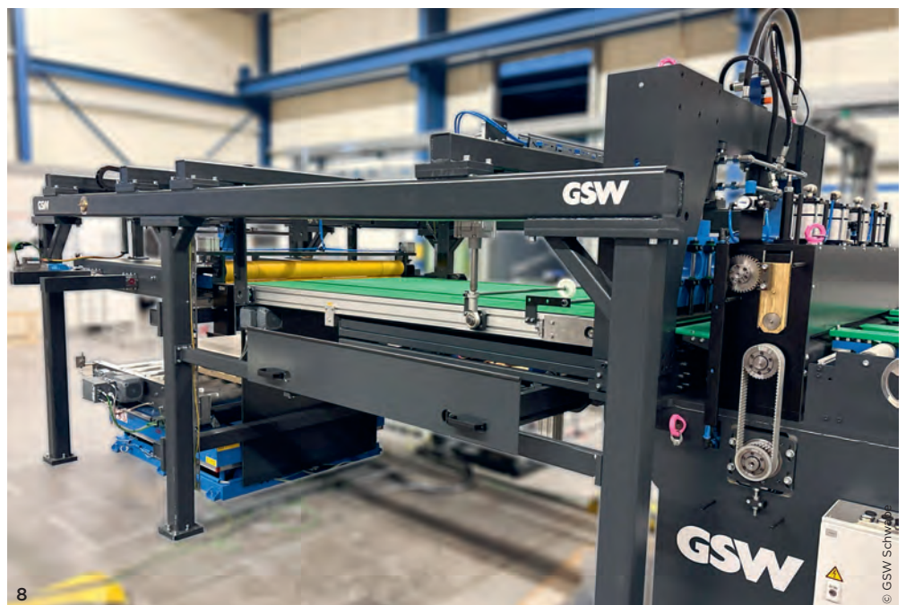
8 Entnahmeverrichtung für Schrott und Probenbleche vor dem Stapler. Rechts im Bild ist die Dachschnitt-Schere zu sehen. Das Förderband kann pneumatisch hochgeklappt werden. Dann kann entweder Schrott in einen Container oder ein Probenblech in die Schublade gelangen.
