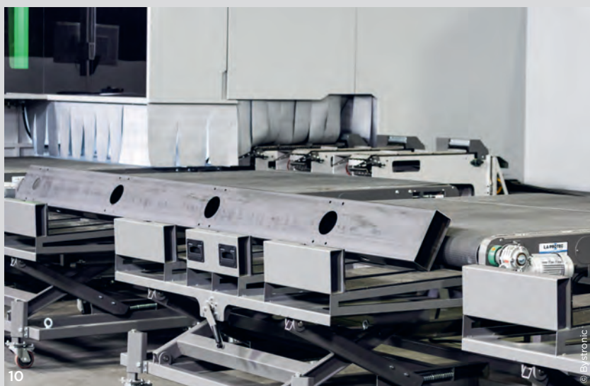
10 Der automatisierte Entladespeicher der Bytube Star 330 erleichtert die Intralogistik. 11 Mit der Bedienoberfläche BySoft Cell Control Tube bringt Bystronic alle Funktionen rund um das Laserschneiden von Rohren und Profilen auf einen Touchscreen.
