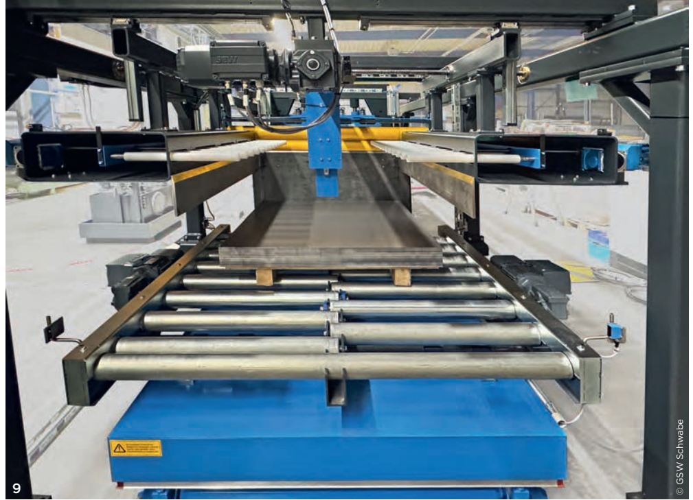
9 Der Hubtisch ist beim Kunden im Boden versenkt montiert. Zu sehen sind die Fingerrollen, die zur Seite fahren und das Blech auf den Stapel sinken lassen, außerdem in der Mitte der Hinteranschlag, der für präzises Ablegen sorgt.
