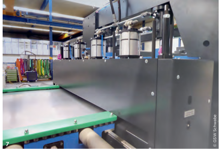
6 Der Saumschrott wird drehmomentgesteuert aufgewickelt, die Haspel ist konisch, so dass das Abziehen des Saumschrottcoils einfach ist. Da ein Kran nicht nutzbar war, dient ein passend konstruierter Wagen dem Abtransport. Im Hintergrund ist die Besäumschere zu sehen. 7 Der Bandeinlauf in den Walzenvorschub: Unter den grünen Abdeckungsstreifen sind die Präzisionskugellager zu sehen, die das einlaufende Blech für die Schere präzise ausrichten.
