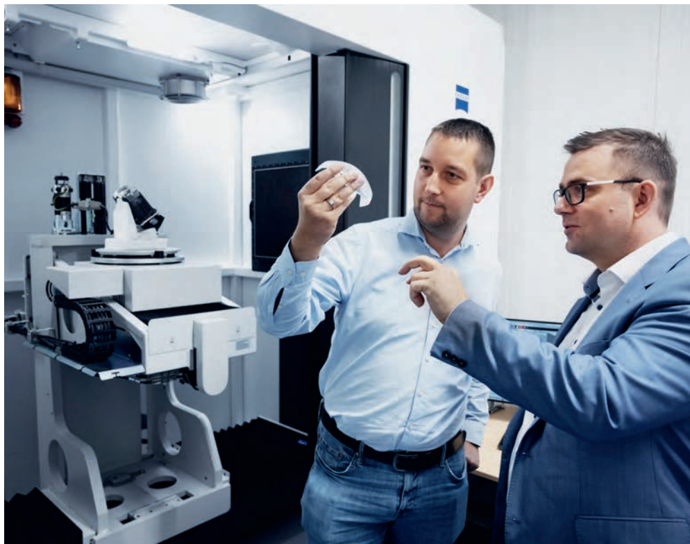
22_Computertomographie in der Blechbearbeitung ZKW Lichtsysteme nutzt die zerstörungsfreie Prüfmethode um komplexe, fertig montierte Baugruppen zu analysieren.
