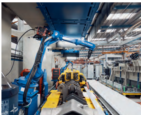
28_Autonome Fertigungszelle übernimmt Manipulations- und Fügeprozesse.
