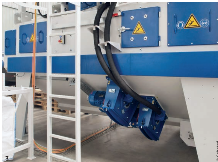
3 Die Strahlleistung und Platzierung der sechs Turbinen – drei oben, drei unten – gewährleisten, dass das Strahlergebnis auch mit verschleiß-armem, rundem Strahlmittel erzielt wird.
