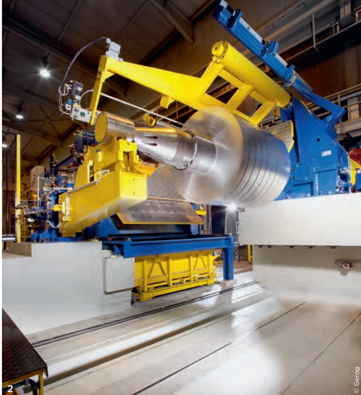
2 Die Längsteil-anlagen von Georg – hier eine bereits gelieferte Anlage – zeichnen sich durch hohe Wickelgenauigkeit aus.
