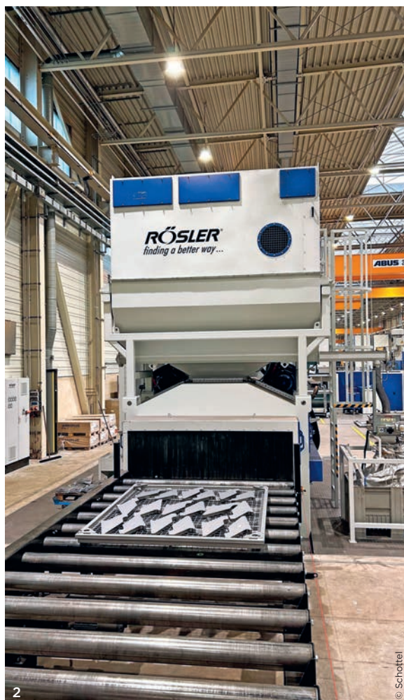
1 Die in den Farben von Schottel lackierte Rollenbahn-Strahlanlage ermöglicht eine wiederholgenaue Qualität in der Produktion.
